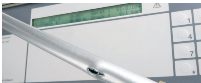
Resultatet av ett sprängtrycksprov med universälrör RAUTITAN Flex.
