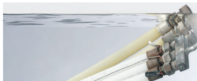
Rör i ett långtidstest (under tryck i vattenbad)
